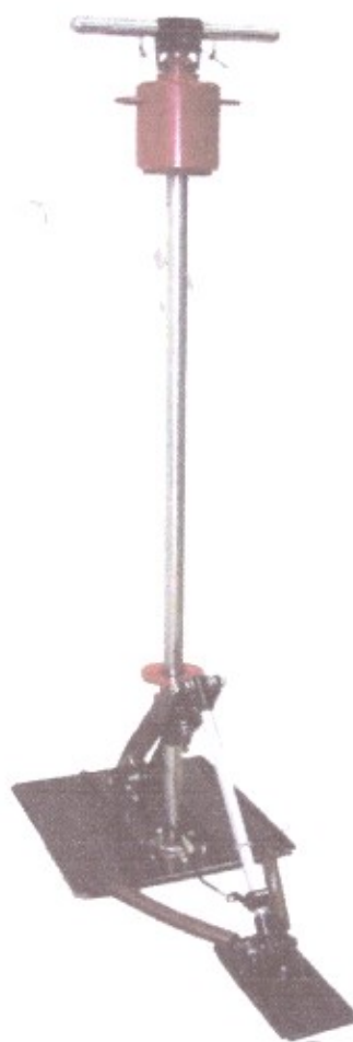
Рисунок 1.3 – прибор для определения коэффициента сцепления дорожного покрытия ИКСп-РДТ
